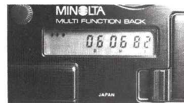
Helt til venstre ses tre »ruder«, som angiver eksponeringsstyrken (indstilles efter filmtypen). Derefter følger de seks LCD-tal, som i dette tilfælde angiver klokkesættet. Helt til højre ses indkodningstasterne, som normalt skjules af et dæksel.
